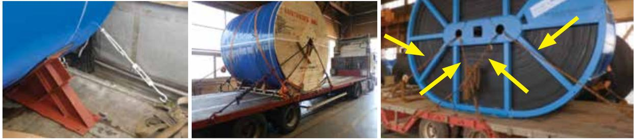
**Abbildung 5: Empfohlene Methode zur Gewährleistung der Sicherheit und zum ausreichenden Schutz der Rollen vor dem Transport**
