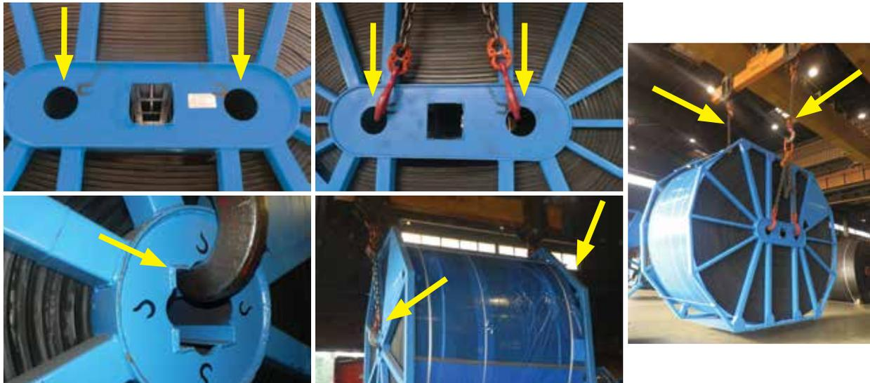
**Abbildung 3: Offene elliptische Rollen und offene Stahlrollen - empfohlene Methode zum Heben der Rolle mithilfe geeigneter Hubvorrichtungen (eine Hebeschlinge ist Mindestvoraussetzung)**
