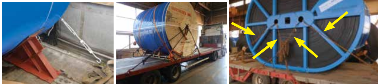
Obrázek 5: Doporučený způsob zajištění bezpečnosti a ochrany cívek před přepravou
